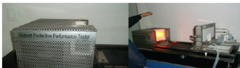
Рис. 1. Прибор для определения устойчивости к воздействию теплового потока, пакетов материалов, подвергаемых воздействию источника теплового излучения
