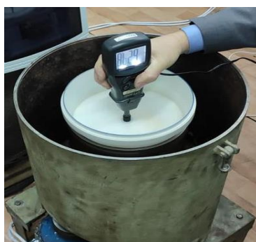
Рисунок 2 - Определение оборотов центрифуги с помощью цифрового универсального тахометра АТТ 6000
