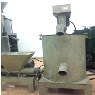
Рисунок 3 - Центрифуга для разделения жира от шквары.
