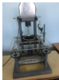
Рисунок 1 – Установка для циклического деформирования пакета со швом (а - схема установки, б - фотография установки) [материал авторов]
