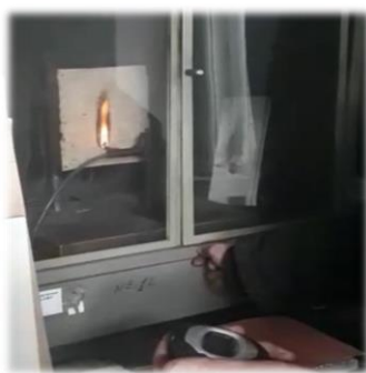
Сурет 4 – «ОВТ» құрылғысында бейматаның жануға төзімділігін сынау
