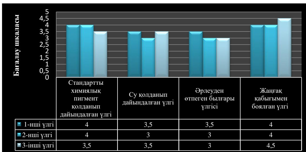
Сурет 1 – 30 минуттан кейінгі үлгілердің су тамшысына бояу тұрақтылығының көрсеткіші
