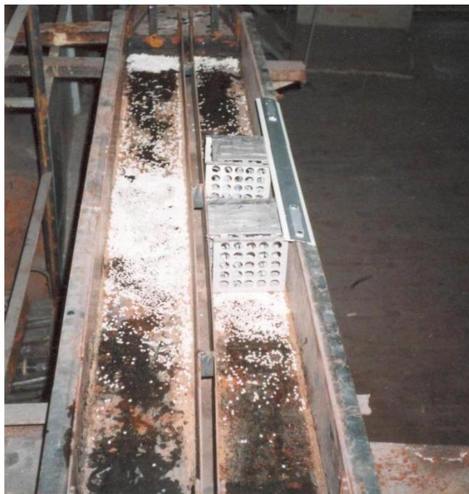
Рис. 7. Работа отстойника с кассетами и без них.
