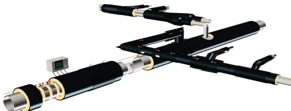
Сортамент труб соответствует стандарту (ISO 4200/DIN2458)? и изготавливаются они из ст.37. Коэффициент прочности сварных соединений равен 1, так как сварка фитингов производится с помощью автоматов и весь процесс сварки записывается и активируется с помощью компьютера.
