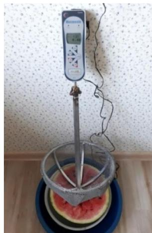
Рисунок 4 - Пресс-сито с динамометром
