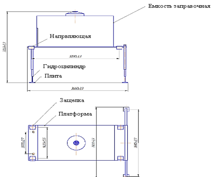
Рисунок 4 – Конструкция рабочего оборудования заправщика
