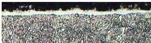
Рис. 1. Слой карбонитрида (белый) с высокой твердостью на поверхности карбонитрированной детали
