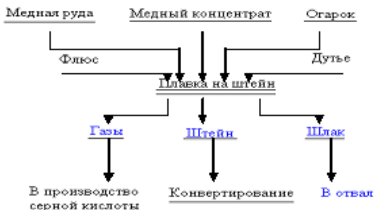
2-сурет. Мыстың пирометаллургиялық бөлімінің принципіалдық сұлбасы
