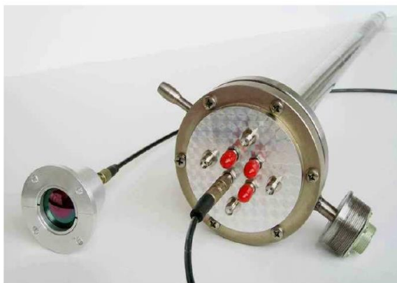
Рис. 3. Внешний вид монитора тепловых нагрузок с одним присоединенным транспортным оптоволоконном и входным объективом
