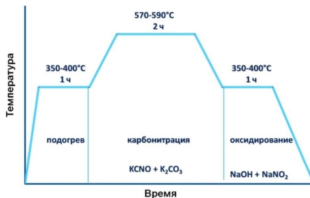
Рис. 2. Технологическая схема карбонитрации
