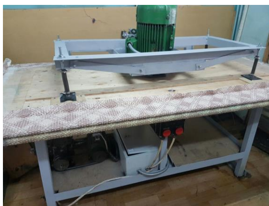
Рисунок 2 - Общий вид машины для изготовления и предварительного уплотнения основы валяльно-войлочных изделий в рабочем состоянии.
