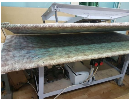
Рисунок 3 - Общий вид машины для изготовления и предварительного уплотнения основы валяльно-войлочных изделий в момент заправки полуфабриката для валки.
