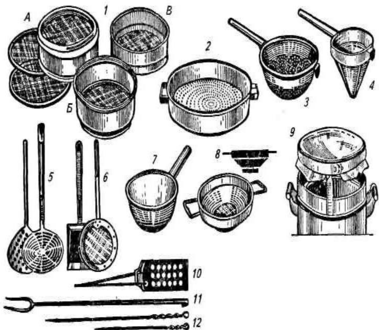
6.24-сурет. Ыстық цех инвентарі: 1-електер; А алмалы-салмалы торлы және пластмасса қырлы; Б- тот баспайтын торлы және алюминий қырлы; В- қыл торлы және ағаш қырлы; 2- металл елек; 3- сыйымдылығы 7 л металл дуршлаг; 4-металл конусты елек; 5-кепсер; 6- шөміш-торлар; 7- бақыр; 8- металл сүзгі; 9-сорпаны сүзуге арналған құрал; 10- лақтырғышпен аспаздық қалақша; 11-кәуап қуыруға арналған істік
