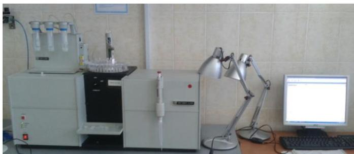
Рисунок 2 – Спектрометр с электрической атомизацией «КВАНТ-Z.ЭТА-T»
