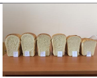
Рисунок 3 - Изменение структуры хлеба в зависимости от содержания тыквенного пектина
