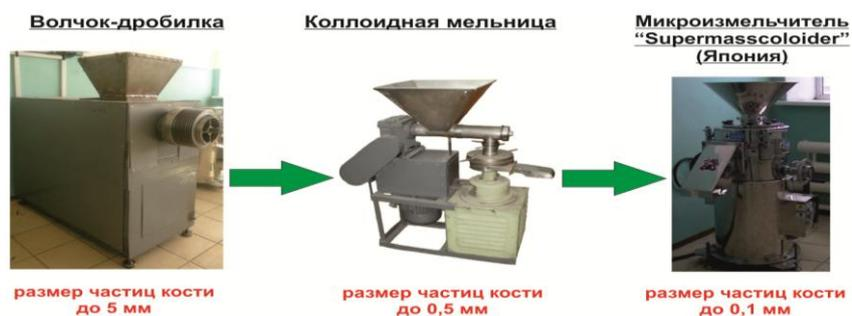
Рисунок 1 - Схема многостадийного способа измельчения мясокостного сырья
