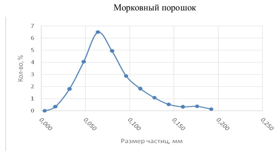
Рисунок 5 - Гранулометрический состав полидисперсной нутовой, чечевичной, амарантовой муки и морковного порошка
