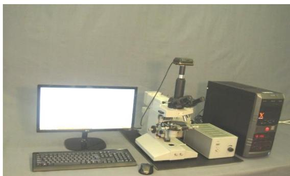
Рисунок 1 – Информационно-измерительная система ГИУ-1 для определения гранулометрического состава порошкообразных материалов
