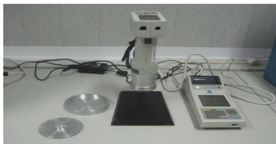
Рисунок 3 – Прибор для определения цветовых характеристик муки «Chroma meter CR-410» - фирма «Konica Minolta» - Япония
