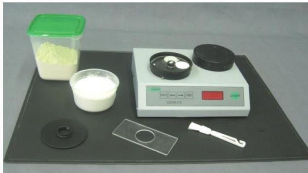
Рисунок 2 – Прибор «Белизномер Блик Р3» для определения белизны пшеничной и ржаной муки
