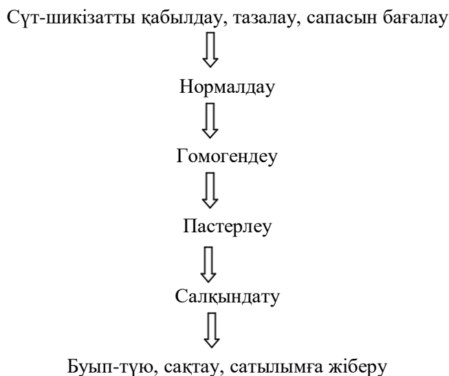
Сурет 1 – Ішуге арналған сүт өндірісінің технологиялық схемасы
