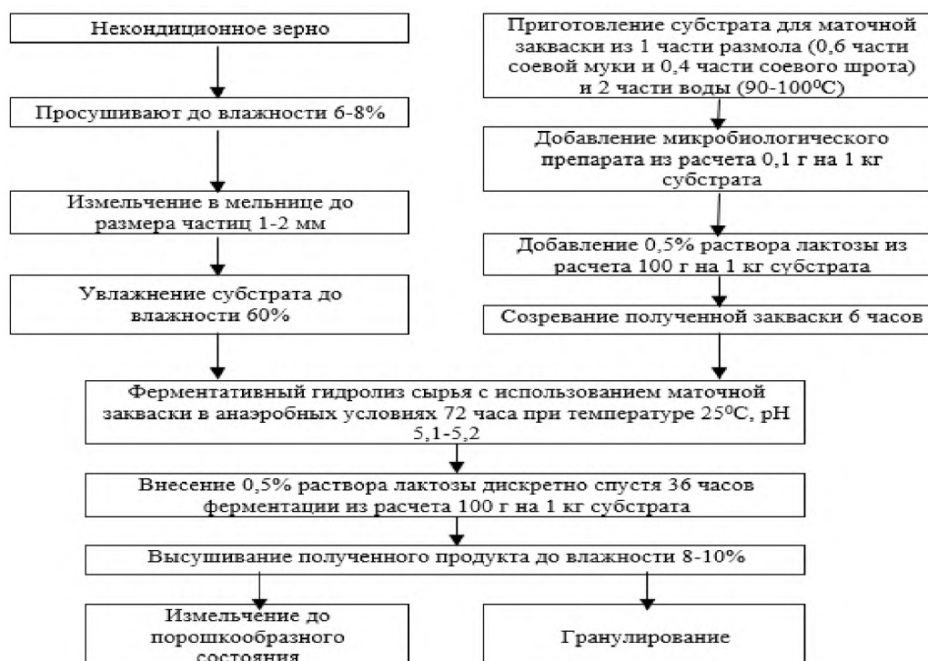
Рисунок 2 – Технологическая схема кормового продукта путем переработки некондиционного зерна с использованием закваски на основе соевой муки и шрота
