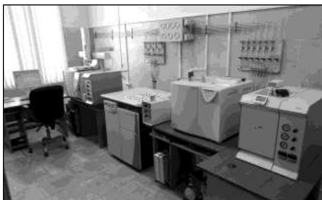
Рисунок 2 – Аналитический комплекс для исследования состава стабильных изотопов легких элементов на базе IRMS/SIRA масс-спектрометра ThermoFisher Scientific Delta V Advantage (ЦКП (НОЦ) РУДН)
