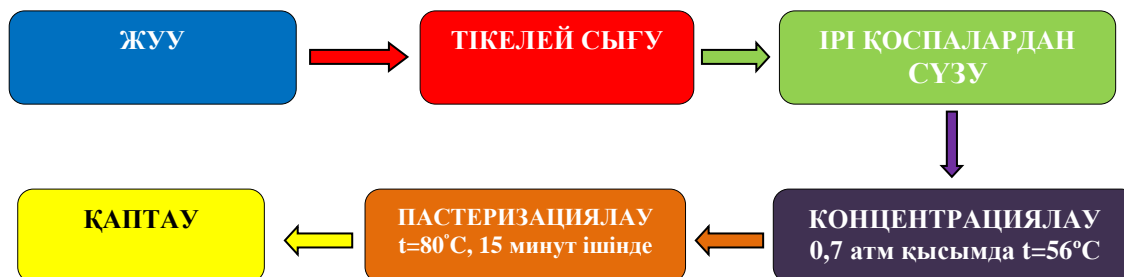
1-сурет - Жүзім, алма және шие концентраттарын дайындаудың технологиялық схемасы
