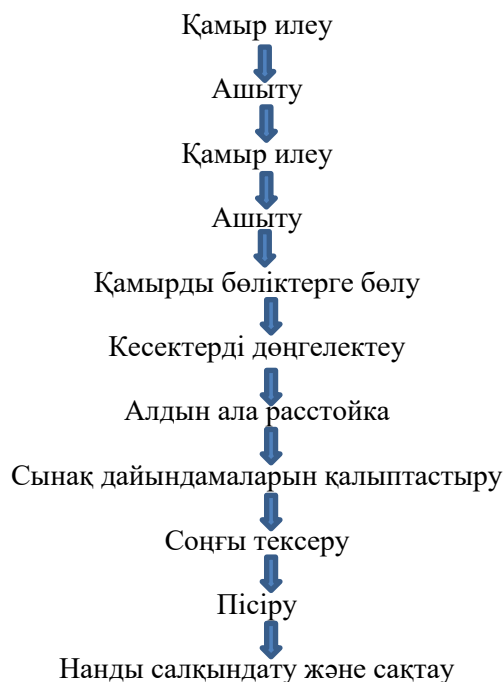
4-сурет. Нан дайындау өндірісінің технологиялық схемасы
