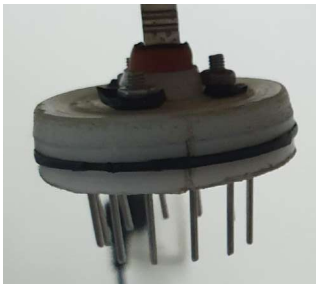
Рисунок 3 – Фильтра с 12-ю инжекторами
