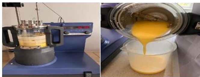
Сурет – 1 IKA LR 1000 basic base зертханалық реакторында эмульсия алу
