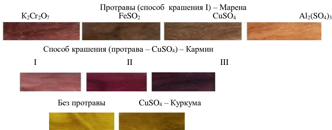
Рисунок 3 – Изменение цветового тона в зависимости от природы протравы и условий крашения.
