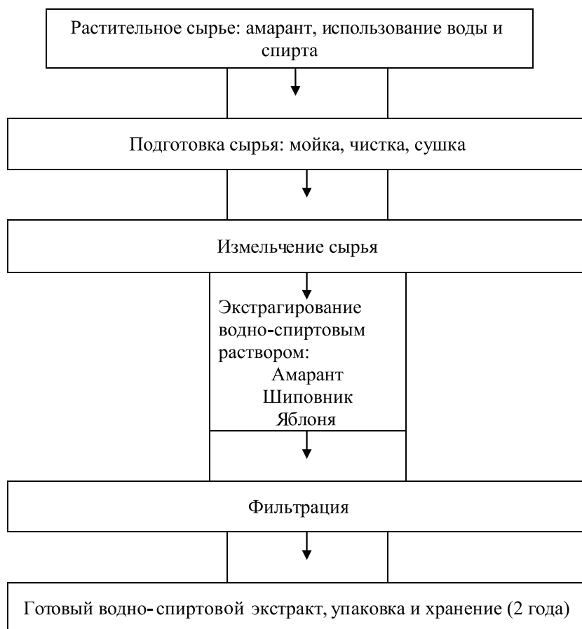
Рис. 2. Принципиально-технологическая схема получения экстрактов
