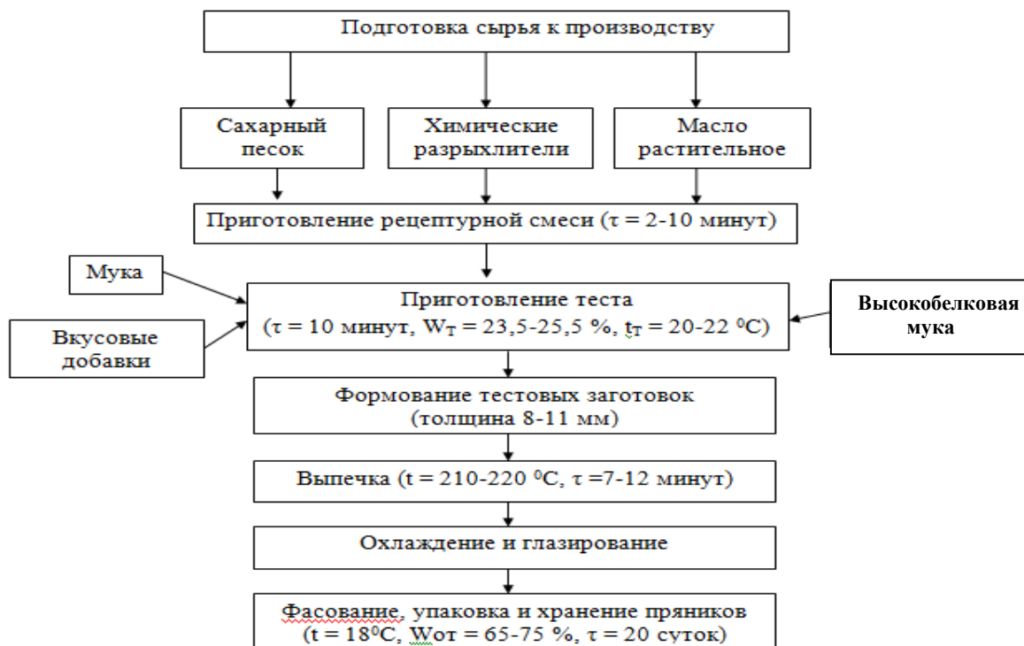
Рисунок 1 – Схема приготовления сырцовых пряников с заменой части пшеничной хлебопекарной муки в/с на высокобелковую муку
