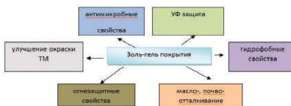
Рисунок 2. Золь-гель покрытия для текстильных материалов
