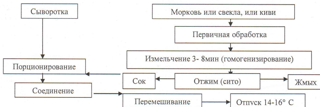
Рисунок 1 - Технологическая схема приготовления функционального напитка
