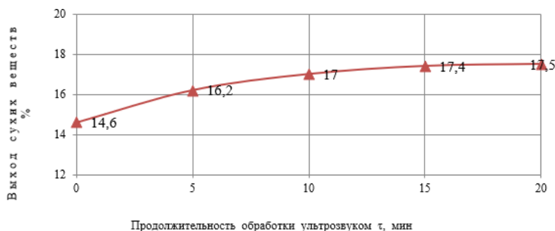
Рисунок 3 - Зависимость выхода сухих веществ из комбинированного экстракта от продолжительности обработки ультразвуком
