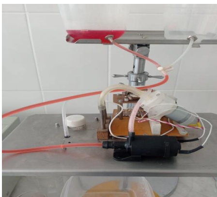
Сурет 2. Шашырату әдісімен капсулалауға арналған жетілдірілген қондырғы
